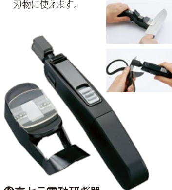
⑩京セラ電動研ぎ器 ファインシャープナー SS-30 202×38×57mm ¥4,200 材質:本体/ABS樹脂、ポリアセタール 砥石/ファインセラミックス 電源:アルカリ単三乾電池2本使用(別売り)
