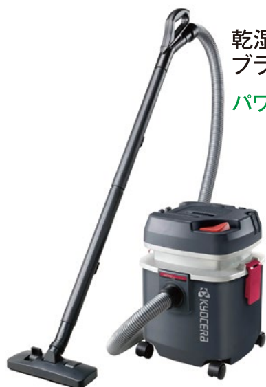
⑥乾湿両用集じん機 ブラシセット (丸ブラシ付) AVC1150 ¥24,800 集じん容量:乾燥15ℓ、液体12ℓ 質量:6.5kg サイズ:長さ345×幅350×高さ435mm 吸込仕事率:280W 電源:単相100V 電流:12A 電源コード:5m
